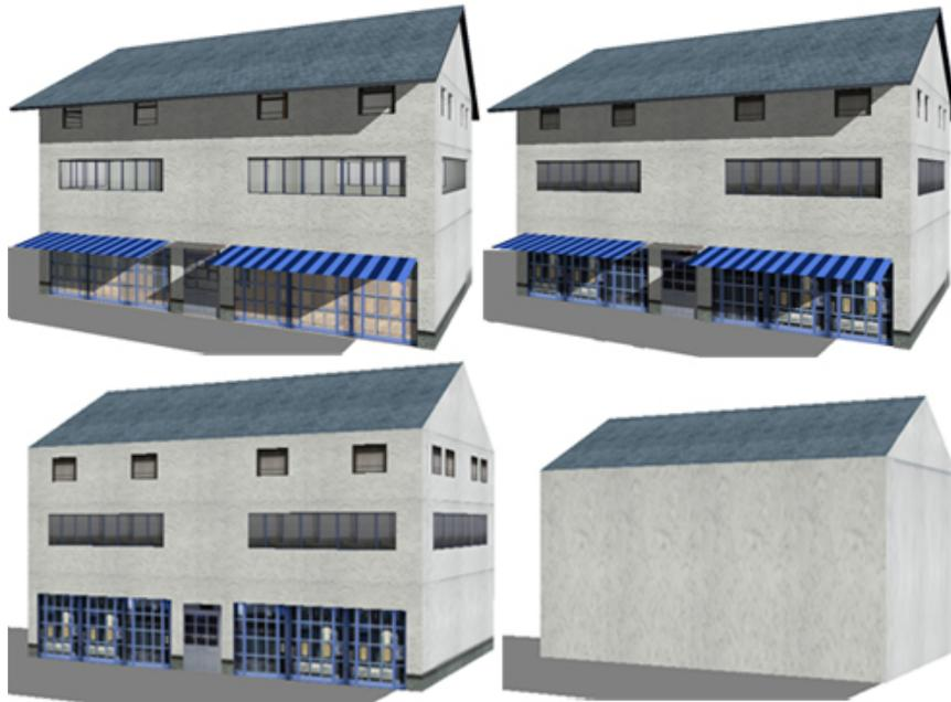
Abbildung 53: Ein Gebäudemodell in vier LOD-Stufen.
