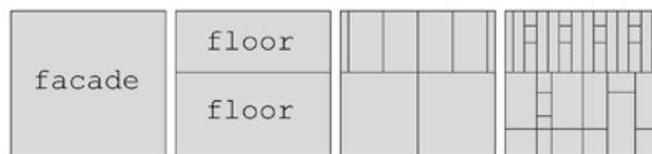
Abbildung 37: Erstellung einer Fassade mit der Split-Grammar-Technik (Quelle: [MuVeU1VG01]).
