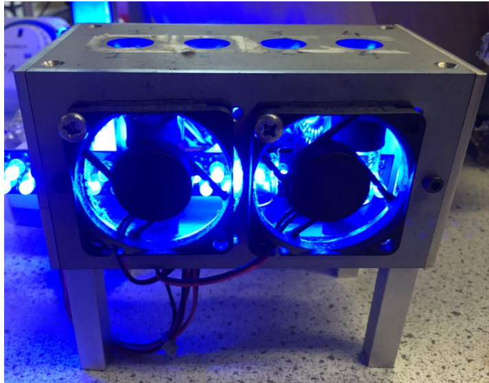
Abbildung 54: Bestrahlungsvorrichtung zur Photokatalyse
