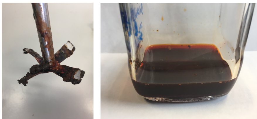
Abbildung 149: Feststoffrückstand am Rührblatt nach der Emulsionspolymerisation (links) und Polymeremulsion (rechts)
