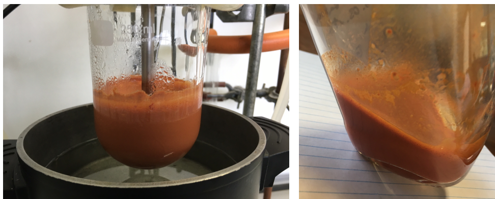
Abbildung 156: Emulsionspolymerisation von [\text{Ru}(\text{EAb})_2\text{TerpyPd}(\text{ACN})\text{Cl}](\text{PF}_6)_2 ( 43 ) mit Methacrylsäureethylester
