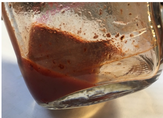
Abbildung 160: Polymerisationsprodukt der Polymerisation von [Ru(DiEAb)_2TerpyPd(ACN)Cl](PF_6)_2 ( 44 ) mit Methacrylsäureethylester
