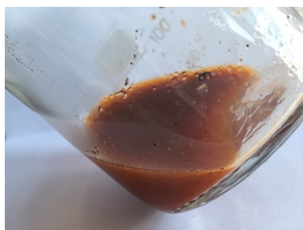
Abbildung 153: Polymerisationsprodukt der Polymerisation von [Ru(DiEAb)_2Terpy](PF_6)_2 ( 42 ) mit Methacrylsäureethylester
