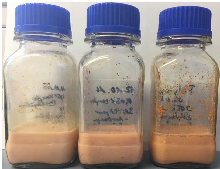
Abbildung 148: Polymeremulsionen der Vorversuche zur Polymerisation von Ruthenium-Polypyridin-Komplexen (von links nach rechts: Methacrylsäureethylester als Monomer, Monomermischung aus drei Monomeren, Methacrylsäureethylester als Monomer nach "Spray-Methode")
