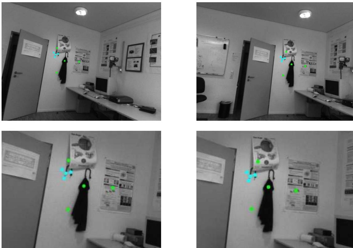
Bild 3.9: 8 Punktkorrespondenzen, generiert aus 2 SIFT-Merkmalen (grün und cyan), die in verschiedenen Skalen liegen.
