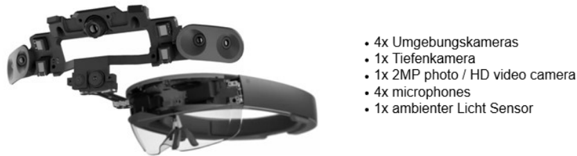
Abbildung 2: Abbildung der HoloLens und ihren eingebauten Sensoren [23].
