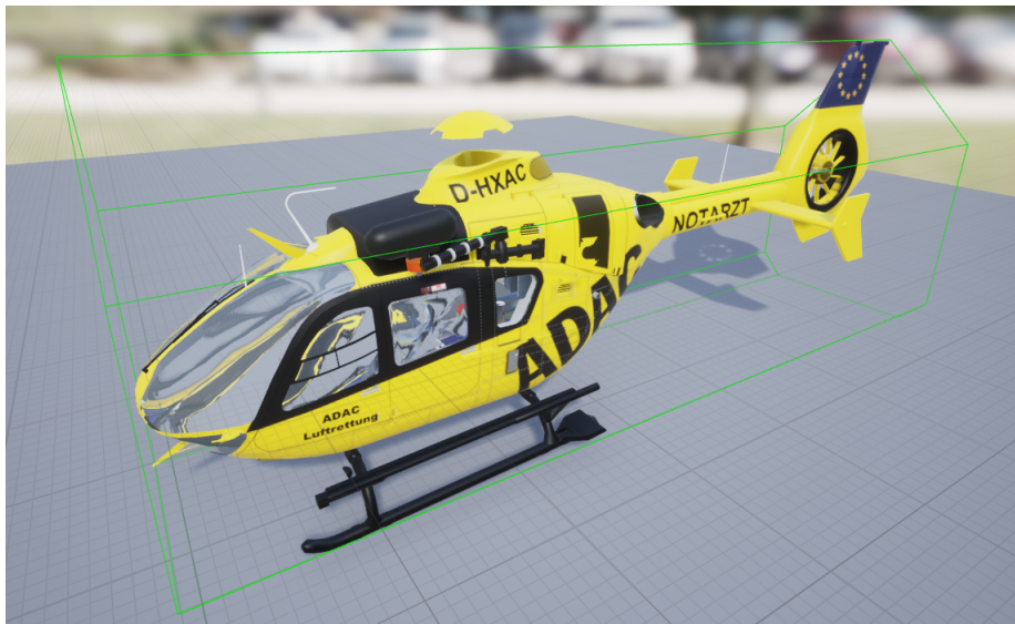
Abbildung 16: Fuselage-Mesh mit Bounding-Box (grün)
