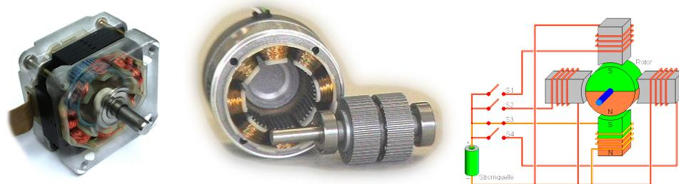
**Abbildung 2:** Links: Schrittmotor mit transparenter Abdeckung, Mitte: Ausgebauter Rotor mit zwei gezahnten und magnetischen Weicheisenkränzen, rechts: Schematische Anordnung der Statoren und des Rotors [Sch]
