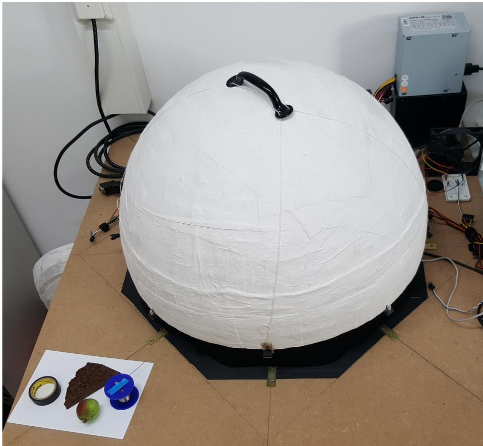
**Abbildung 6:** Finaler Aufbau des Gonioreflektometers von außen. Unten links sind einige 3D-Scan-Objekte und Materialproben zu sehen. Die gesamte Ansteuerungselektronik befindet sich im Bild oben rechts.
