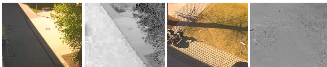
Abbildung 7.1: Zwei Farbbilder der Netzwerkkamera und rechts daneben jeweils das zugehörige, durch Entropieminimierung berechnete, invariante Grauwertbild.
