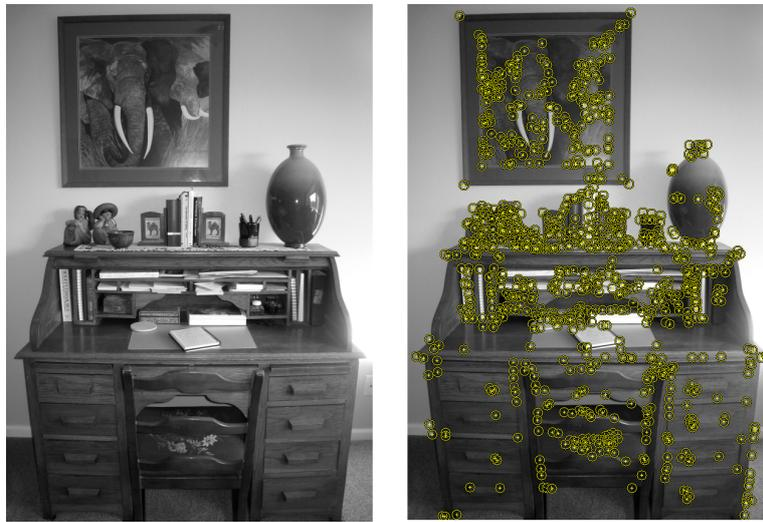
**Abbildung 4:** Im Kamerabild werden visuell eindeutige Merkmale identifiziert und als Feature Points markiert (rechtes Bild). Ecken und Kanten, die einen hohen Kontrast zwischen benachbarten Pixeln vorweisen, eignen sich hierfür am besten. [7]
