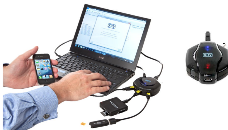
Abb. 2.8: MSAB XRY: Hardware-Kit zur Datensicherung. Quelle: [Tar12]
