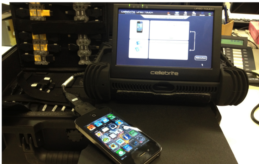
Abb. 2.9: Cellebrites Universal-Forensic-Extraction-Device in der mobilen Ausführung, kurz UFED-touch mit über 100 Adapterkabel und angeschlossenem iPhone 4GSM. Quelle: Eigene Aufnahme 2011.
