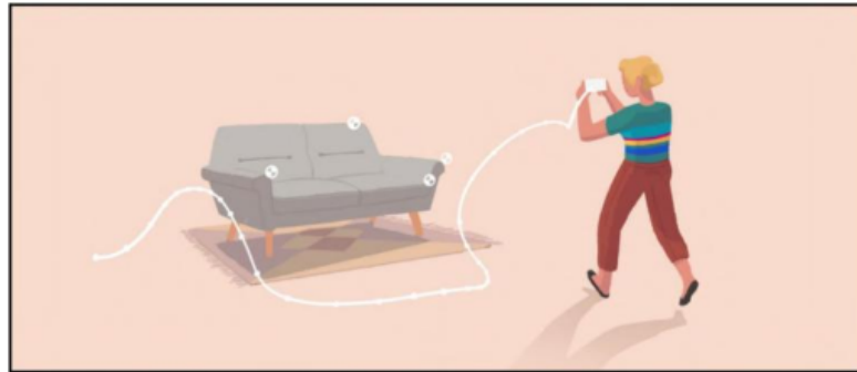
Abbildung 7: Merkmalspunktverfolgung in ARCore (nach Micheal Lanham[Lan18]) Hier werden bestimmte Punkte der Couch als Merkmalspunkte identifiziert.
