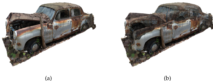
Abbildung 13: Rendering eines Autowracks [Ren]. (a) Ist der Offset-Wert passend gewählt, setzt sich die Farbe der abgebildeten Oberfläche aus allen zugehörigen Splats zusammen. (b) Ein zu hoher Offset-Wert sorgt dafür, dass auch Splats von verdeckten Oberflächen in die Berechnung mit eingehen. Oberflächen werden dadurch transparent dargestellt.
