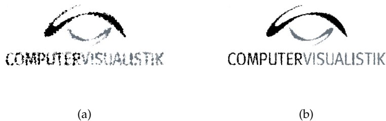
Abbildung 15: Splating einer texturierten Oberfläche. (a) Bei einem einfachen Splating mit scheibenförmigen Splats entstehen in kontrastreichen Bereichen der Textur Verdeckungsartefakte, welche die Sichtbarkeit von Details vermindern. (b) Eine Voronoi-Interpolation der Splats verhindert eine gegenseitige Verdeckung und verbessert die Detailwiedergabe.
