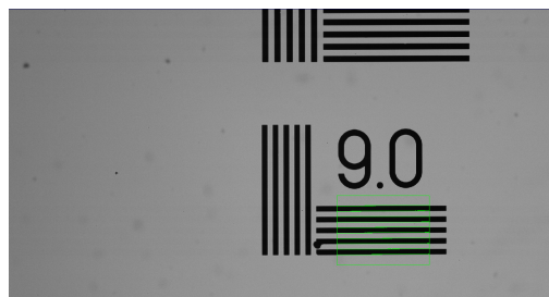
Abbildung 6.1.1.5.: Graphische Darstellung des Linienpaares 9.0 des USAF mit den ROIs für die Kontrastberechnung (Objektiv TC23004 )
