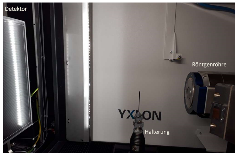
Abbildung 7.2.1.1.: Darstellung des Messaufbaus mit dem CT, bestehend aus einem Detektor, einer Röntgenröhre und einer Halterung für das Objekt
