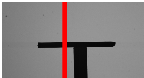
Abbildung 6.2.1.9.: Graphische Darstellung der Aufnahme des Prüfstiftes 72 TPI mit eingezeichneter ROI (Objektiv TC23004 )
