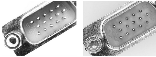
Abbildung 5.3.4.1.: Eine Aufnahme mit einem entozentrischen (links) und einem telezentrischen Objektiv (rechts) [35]
