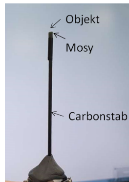
Abbildung 7.2.1.2.: Messaufbau für die CT-Messungen mit Hilfe eines Karbonstabs und Mosy, in dem das Objekt positioniert werden kann
