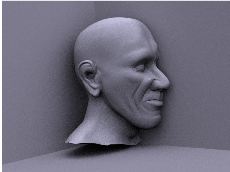
Abbildung 6.1: Testszene Head mit bildbasierter Beleuchtung durch die Light Probe Uffizi Gallery und Ambient Occlusion mittels 36 Samples pro Fragment verteilt durch die 2D Hammersley-Sequenz mit Random Digit Scrambling.
