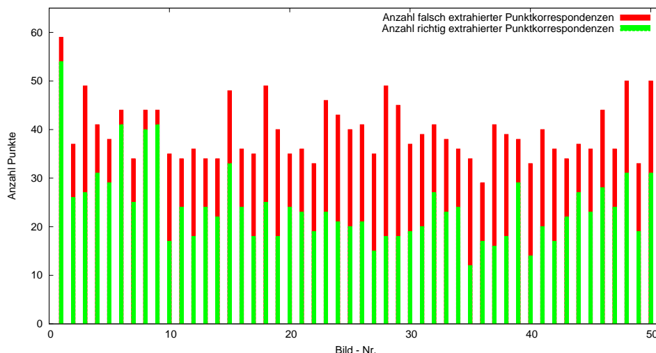
Bild 4.5: Gegenüberstellung der Anzahl von falsch und richtig extrahierten Punktcorrespondenzen für jedes Bild der Testsequenz.
