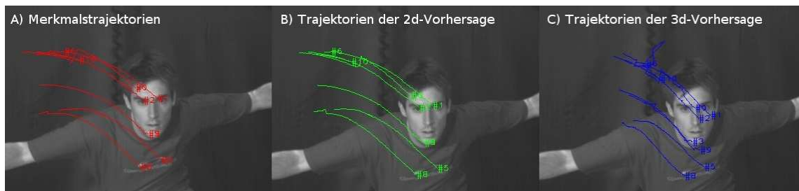
Bild 4.23: Trajektorien der Harris-Corners und den korrespondierenden Vorhersagen bei einer parallelen Bewegung.
