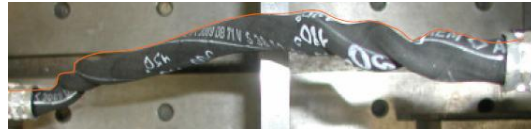
Abbildung 4.1: Bei sehr großer Torsion, hier 720 Grad, neigen einige Schlauchproben zu Knickeffekten (Buckling). Quelle: Daimler AG.
