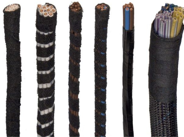
Abbildung 7.3: Zur Überprüfung der Durchmesserberechnung wurden homogene und inhomogene Kabelbündel verglichen.
