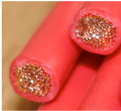
Abbildung 6.21: Real vermessenes Kabel mit vereinfacht angenommenen koaxialem Querschnitt.
