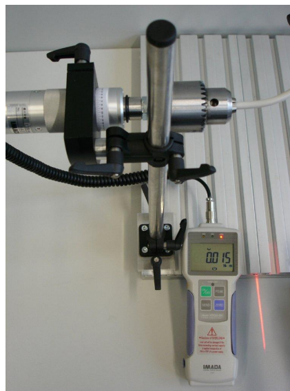
Abbildung 6.4: Das Torsionsmessgerät zeigt die Kraft an, welche zur Rotation benötigt wird. Das Gerät ist auf ein tausendstel Nm genau. Auf der Skala kann man den Rotationswinkel ablesen.
