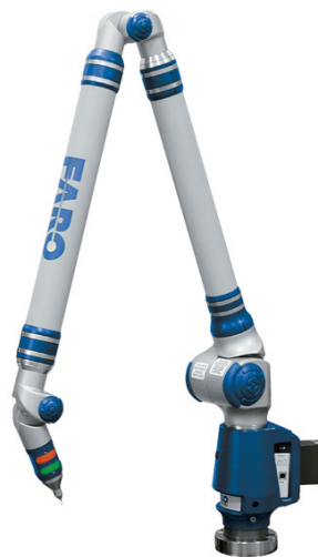
Abbildung 3.2: Der FaroArm Platinum errechnet aus den Winkeln der Gelenke die Position des Messkopfes auf 0.13 mm genau. Quelle: www.faro.com.
