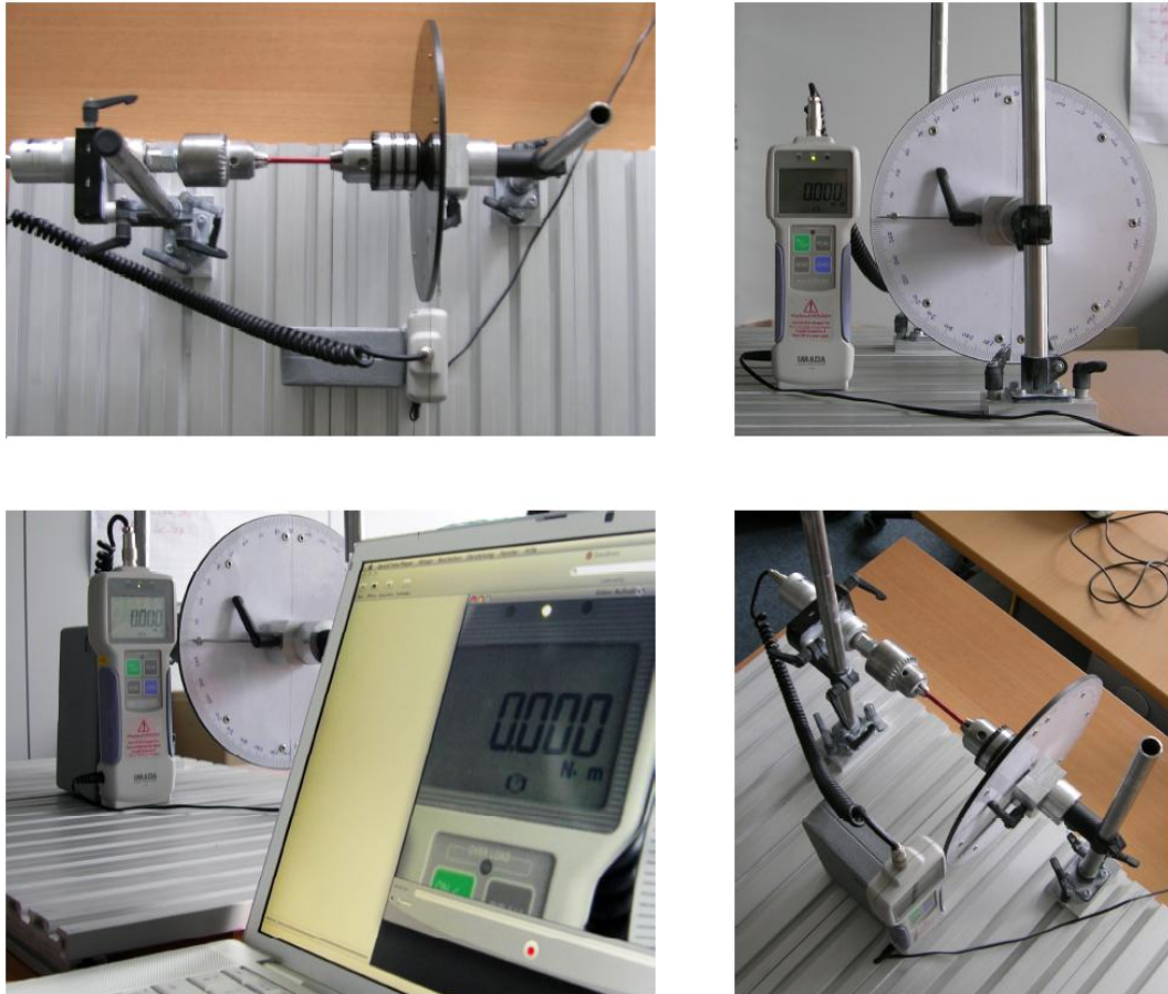
Abbildung 5.17: Der überarbeitete Drehversuch eröffnet die Möglichkeit, gradgenau zu torquieren und durch eine Kugellagerung ein Feedback über den elastischen Bereich der Probe zu geben.
