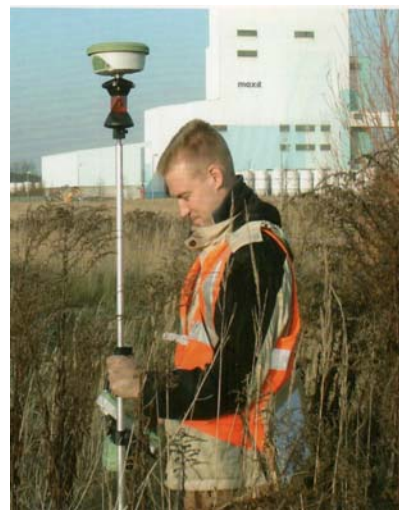
Abb. 3: Messung im Feld mit mobiler Rover-Ausrüstung
