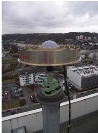
Abb. 2: Antenne der SAPOS ® -Referenzstation in Koblenz
