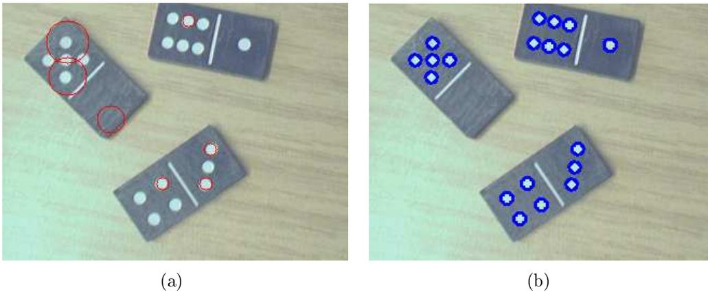
**Abbildung 2.4:** Vergleich einer Kreiserkennung von OpenCV und PUMA. Abbildung 2.4(a) zeigt das Ergebnisbild einer Kreiserkennung ohne manuelle Einstellung der Parameter unter Verwendung der OpenCV Bibliothek. Das Ergebnis der Kreiserkennung von PUMA ist in Abbildung 2.4(b) dargestellt.
