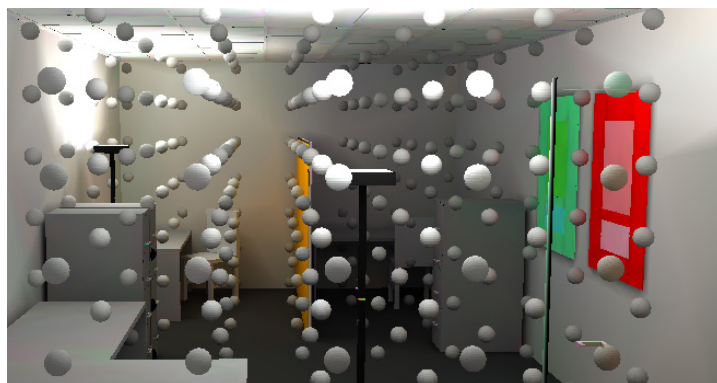
Abbildung 5: Beispiel für ein Irradiance Volume . Die Bestrahlungsstärke-Verteilungsfunktion in einer Gitterzelle ist als Kugel visualisiert. Abbildung entnommen aus [Greger 1996, S. 66].
