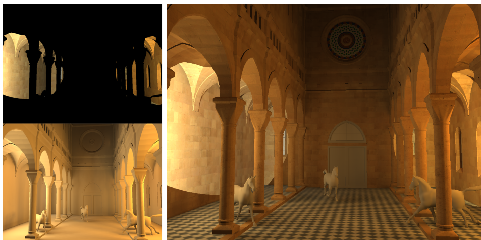
Abbildung 1: Mit dem in dieser Arbeit entstandenen Programm berechnete Beleuchtung mit zwei Interreflexionen in einer rein diffusen Szene. Links oben die direkte Beleuchtung, darunter die indirekte Beleuchtungsstärke, rechts das finale Bild.
