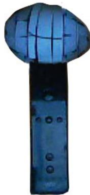
**Abbildung 24:** Dieser Aufsatz mit dem reflektierenden Material wurde auf der Wiimote angebracht. Aufgrund der Größe und der Form eines Eies kann der Aufsatz sehr gut auch aus ungünstigen Winkeln verfolgt werden.
