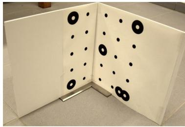
**Abbildung 27:** Beispiel für ein Kalibrieremuster mit dreidimensionaler Ausdehnung. Die zu berechnenden intrinsischen und extrinsischen Kameraparameter sollen in diesem Fall dazu dienen dreidimensionale Objekte zu digitalisieren
