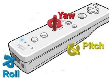
**Abbildung 3:** Die Rotationsachsen im lokalen Koordinatensystem der Wiimote
