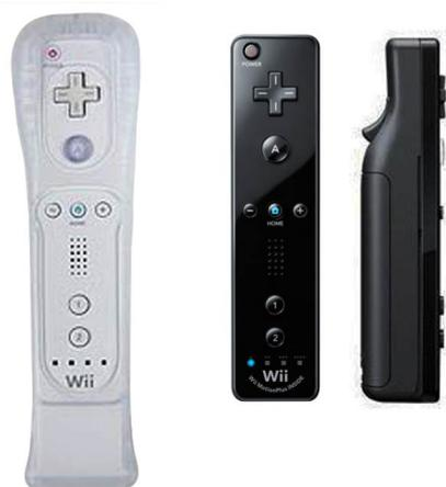
Abbildung 5: Links: Wiimote mit angestecktem MotionPlus Zusatzadapter. Mitte und rechts: In diese Wiimote wurde MotionPlus bereits integriert
