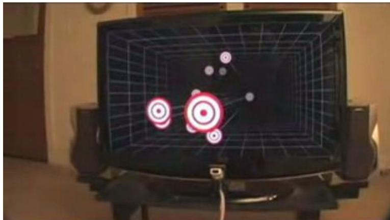
**Abbildung 7:** Demonstration von J.C. Lee's Headtracking. Der Monitor wirkt dabei wie ein Fenster in eine virtuelle Welt. [16]
