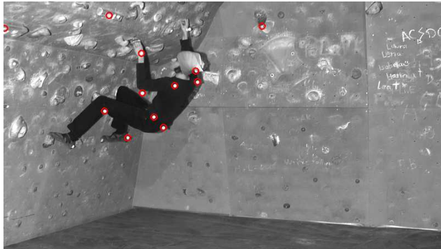
Abbildung 5.4: Das Ergebnis der Markerdetektion auf einem Bild des Videos aus Test 2. Durch die im Vergleich zum ersten Video heller beleuchtete Szene reflektieren vereinzelt Teile von Griffen und werden fälschlicherweise als Marker erkannt.
