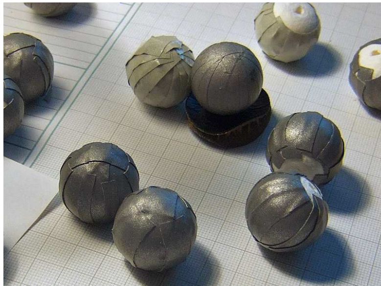
Abbildung A.1: Verschiedene Marker mit unterschiedlicher Herstellungstechnik. Die zwei Marker mit der helleren Folie (oberen Bildhälfte) konnten keine so guten Reflektionseigenschaften vorweisen und wurden bei den Aufnahmen nicht verwendet. Der im Bild mittig liegende Marker mit der glatten Struktur wurde im Handel erworben.
