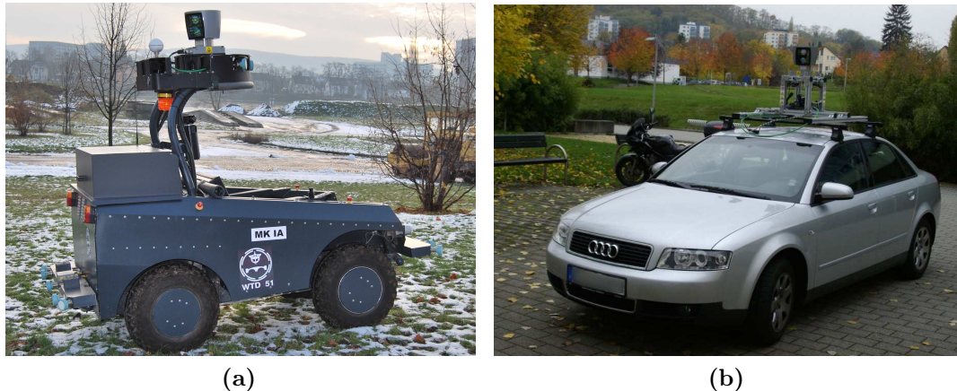
Abbildung 1.1: Testaufbauten: Roboter Mustang Mk 1A (a) und Pkw mit auf einem Dachgepäckträger befestigten Sensoren (siehe [NDPP09]) (b)
