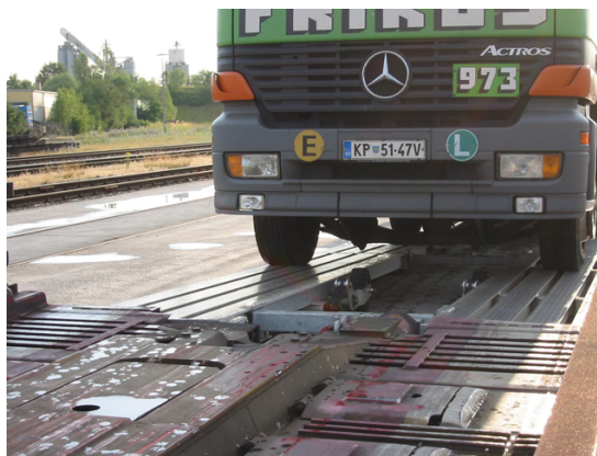
Abbildung 3.4: Auffahrt auf den Zug über die Rampe (1)
