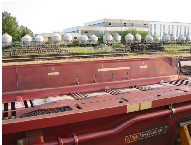
Abbildung 3.7: Positionsmarkierungen auf den Niederflurwaggons
