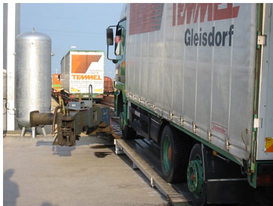
Abbildung 3.5: Auffahrt auf den Zug über die Rampe (2)
