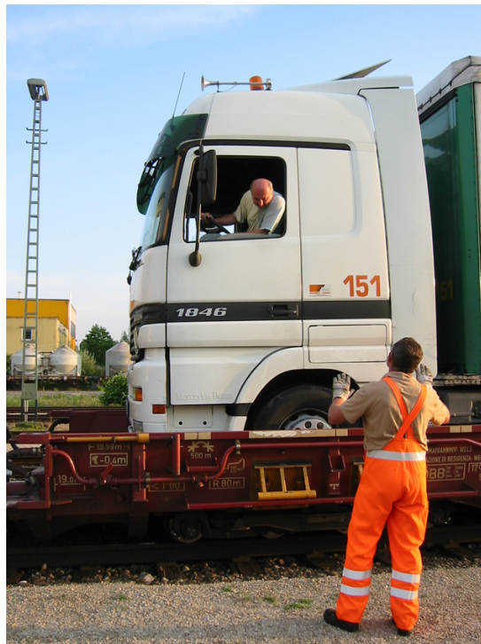
Abbildung 3.7: Positionsmarkierungen auf den Niederflurwaggons
