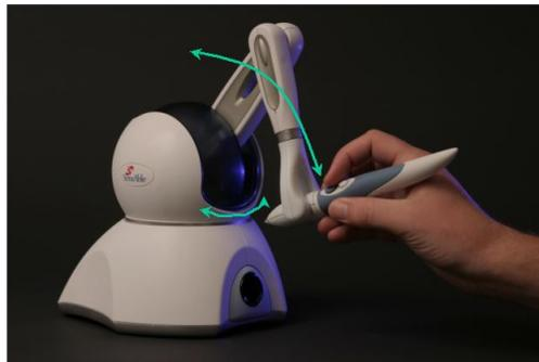
Abbildung 35: Bewegung des Gerätearms, um eine Rotation der Kamera zu erzeugen
