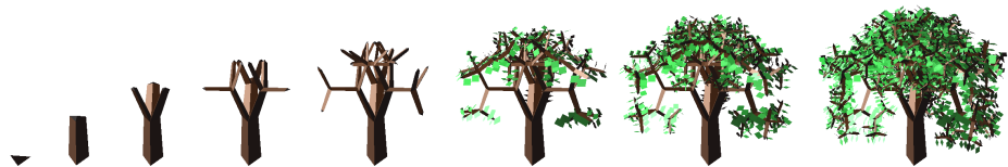
Abbildung 16: Ergebnisbilder „Tree“-Shader, von links nach rechts 0–7 Geometrie-Shader Passes
