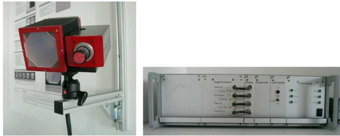
Bild 5.1: Die 3D-Laserkamera mit Kontrolleinheit
