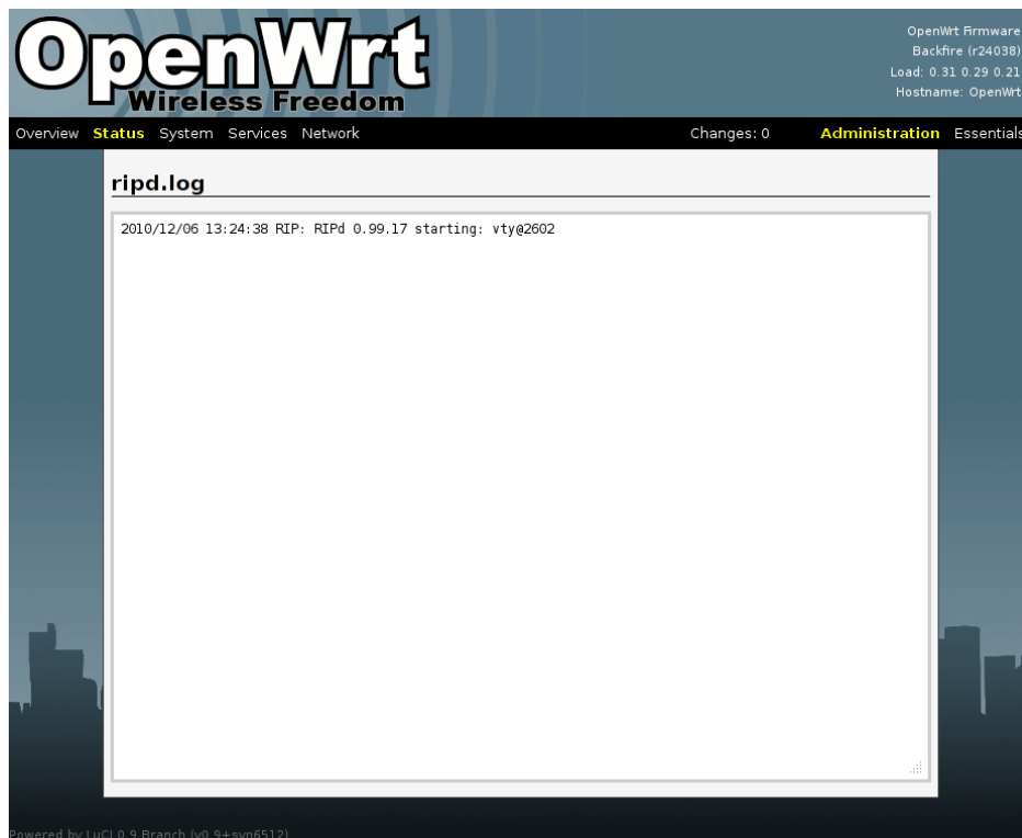
Abbildung 2.13: Anzeigekomponente für die Protokolldatei des RIP Daemon
