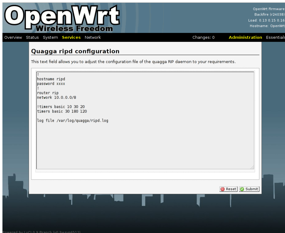
Abbildung 2.12: Konfigurationskomponente für den RIP Daemon
