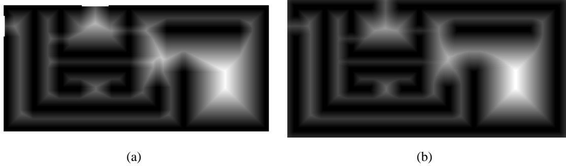
Bild 3.3: Hindernistransformation mit der Schachbrettdistanz (a) und mit der euklid'schen Distanz.
