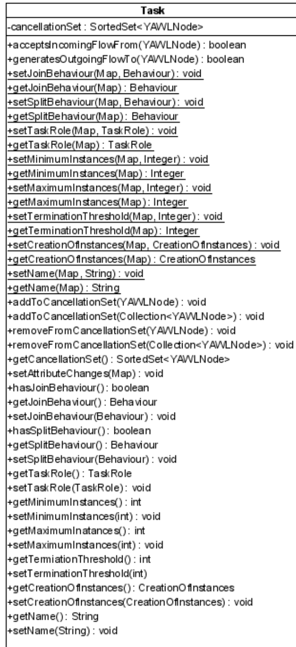
Abbildung 13: UML-Klassendiagramm zur Klasse iprocess.graph.yawl.model.Task
