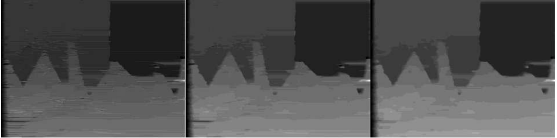
Bild 5.9: Von links nach rechts: Das ursprüngliche Disparitätsbild; mit Medianfilter der Größe 3x3 geglättet; mit Medianfilter der Größe 5x5 geglättet
