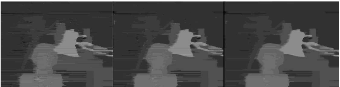
Bild 5.10: Von links nach rechts: Das ursprüngliche Disparitätsbild; mit Medianfilter der Größe 3x3 geglättet; mit Medianfilter der Größe 5x5 geglättet
